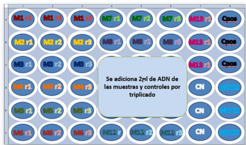
Figura 10. Carga del ADN molde y los calibradores en la placa.
