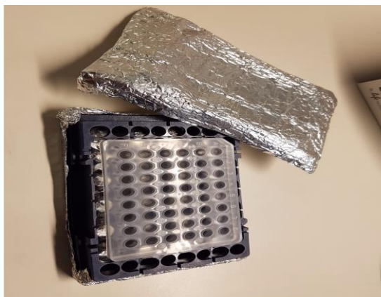
Figura 7. Placa con pocillos para ensayo de PCR Tiempo Real en base cubierta de papel aluminio.
